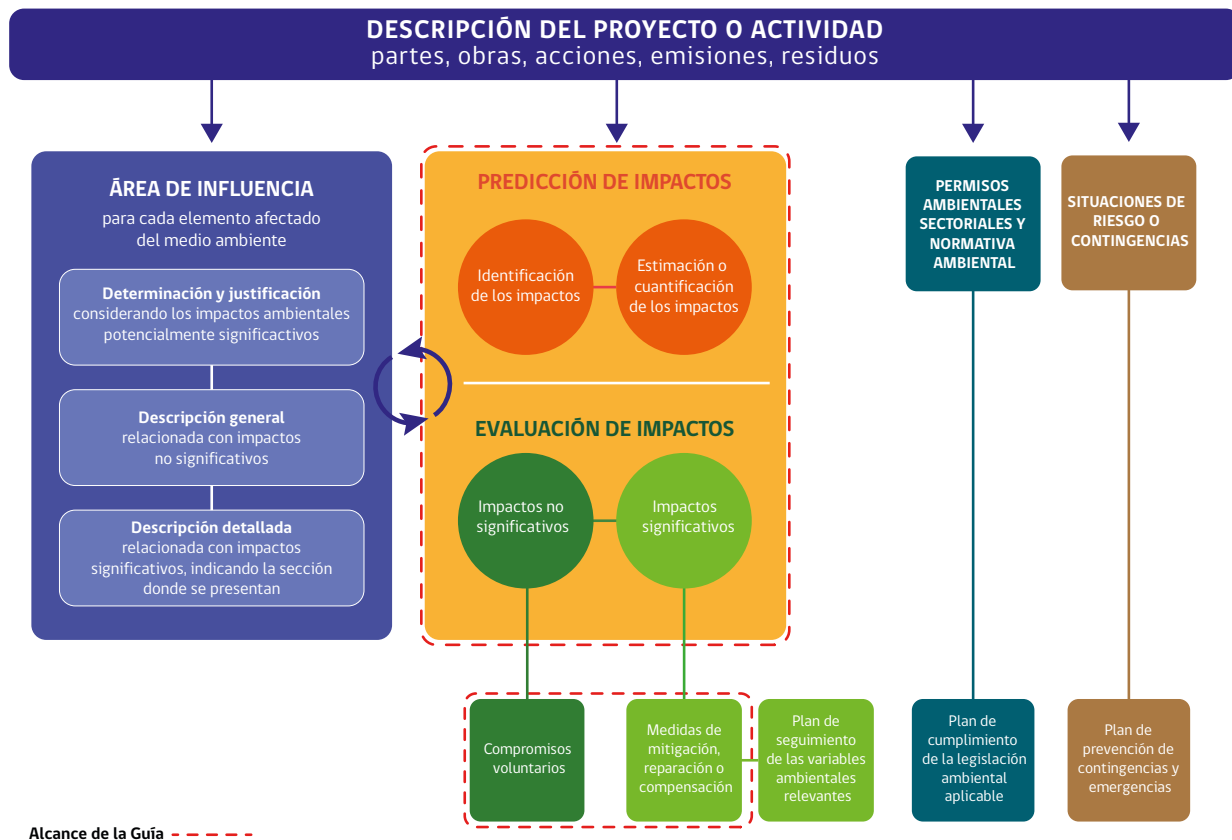
Figura 1. Contenidos y alcances de esta Guía en el proceso de evaluación ambiental
